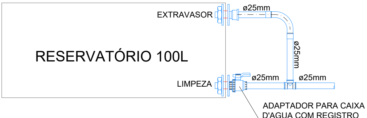
ESQUEMA EXTRAVASOR/LIMPEZA CAIXA D'ÁGUA ÁGUA FRIA-COBERTURA SEM ESCALA
